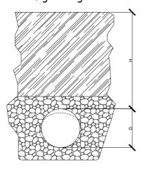
Nel calcolo statico delle condotte in PVC l'unico parametro da tenere in considerazione è la deformazione diametrale dei tubi, nel senso che prima di pervenire ad un collasso del materiale si avrà una deformazione incompatibile con il corretto utilizzo del sistema.
